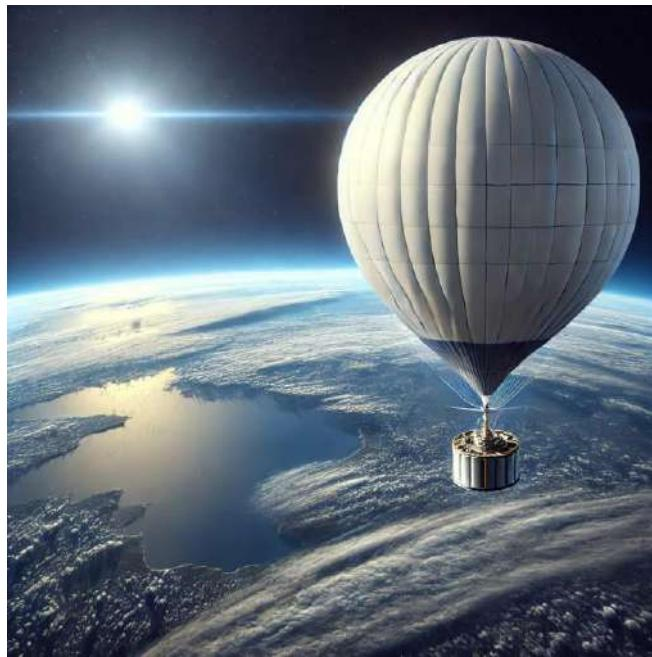
Les ballons stratosphériques jouent un rôle essentiel dans l'étude de l'atmosphère terrestre et dans l'observation de l'Univers depuis une altitude supérieure à celle des nuages. Ces véhicules sans moteur, gonflés à l'hélium, peuvent atteindre entre 20 et 40 kilomètres d'altitude, bien au-delà de la portée des drones et des avions, mais bien en deçà des satellites.
